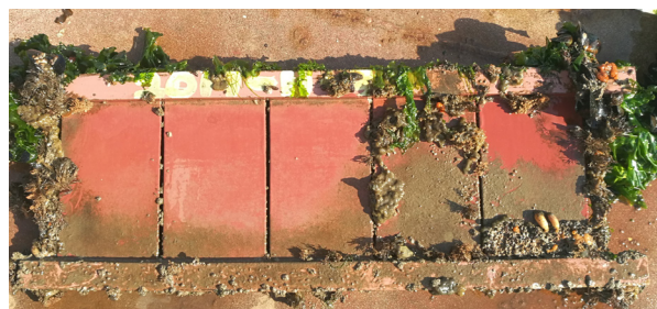
图6 青岛实海挂板试验(防污期效36个月)
